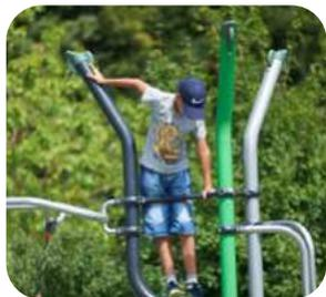
**Ossatures en acier galvanisé à chaud** intérieur et extérieur des tubes + Thermolaquage (peinture poudre polyester cuite au four) : En tube acier diamètre 89mm épaisseur 2,9mm de type E24 traité par galvanisation à chaud (Trempe dans un bain de zinc en fusion) et **thermolaquage** permettant de ne pas souffrir des assauts du temps.
